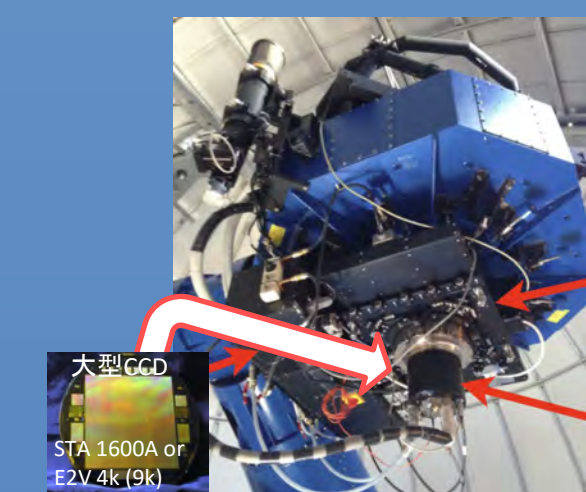
セロ・トロロ国際天文台(CTIO)のT80-SOポット望遠鏡に EZV 9k CCDカメラを借りて 実装し試験観測を行ったSOUTH POL
