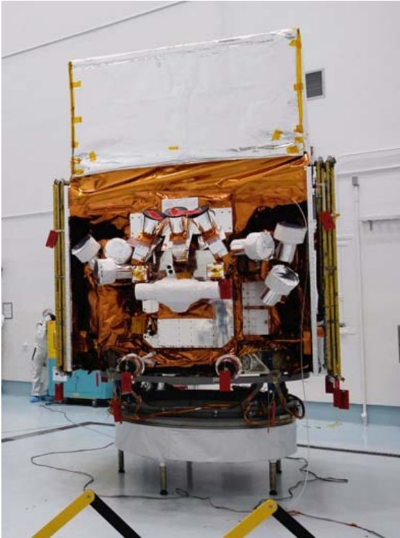
組上がった GLAST 衛星。両側に折り畳まれた太陽電池パネルが見える （NASA 提供）
