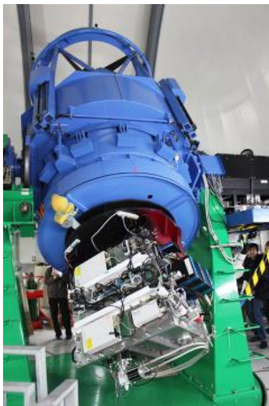
図 1.9: HONIR(近赤外線同時撮像装置)[14]
