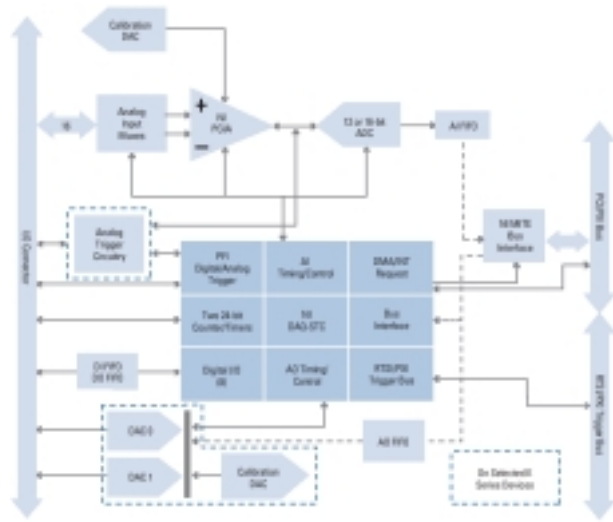
図 3.11: PCI-6024E のブロックダイアグラム
