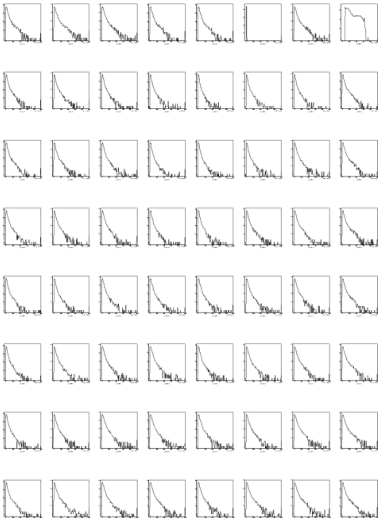
図 4.3: 64chPMT のアノードのスペクトル (Cs-137)
