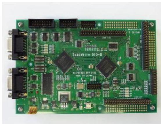
図 3.3: SpaceWire デジタル I/O2 ボード [22]
