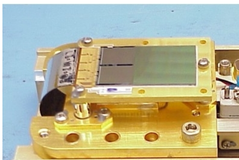
図 2.4: 衛星『すざく』の X 線 CCD XIS [3]
