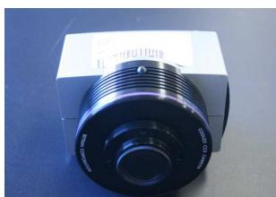
図 2.2: BTRAN社製冷却CCD
