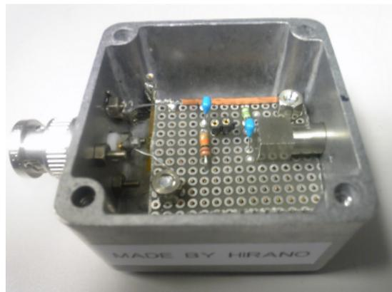
図 5.5: 読み出し回路 (左に HV, 右へ出力)
