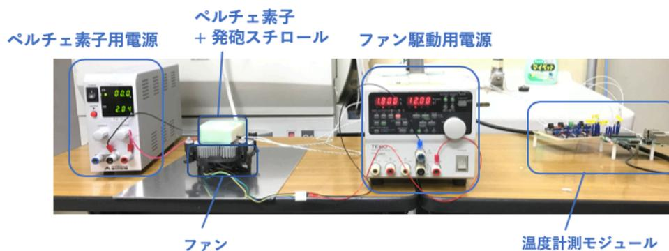
図 4.3: ペルチェ素子の動作確認のための実際のセットアップの図
