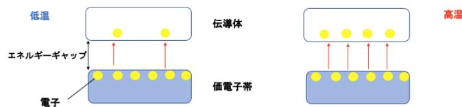
図 3.28: 暗電流の温度依存性の物理的考察のためのバンド構造の概略図
