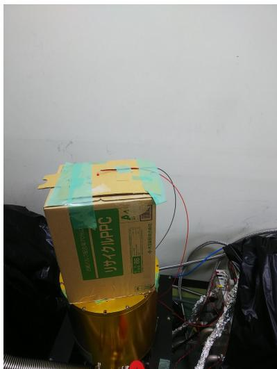
図 3.5: 赤色 LED を用いたリニアリティ測定のセットアップ。LED の電源は TEXIO 電源から供給している。
