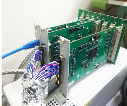
図 2.7: 読み出しシステム。イーサネットケーブルで PC と接続されている。コネクタは FX2-60pin(4 列型)。
