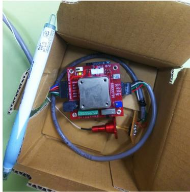
図 3.23: 赤外線レーザーのドライバ。ドライバ右端の白い可変抵抗を回すことで、レーザー出力を変更できる。
