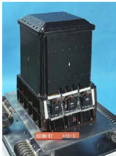
図 3.5: HXD の外観 (The Suzaku Technical Description より)
