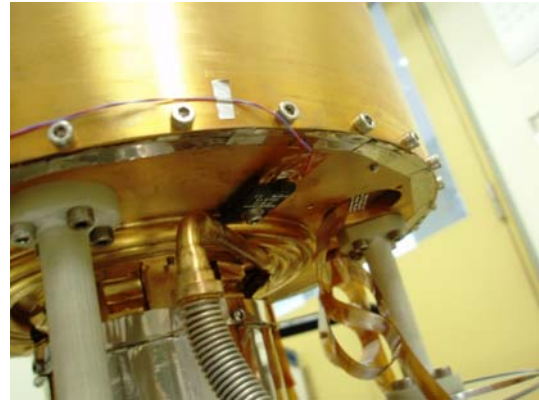
図 5.6: ラジエーションシールド外側底面部のヒーター
