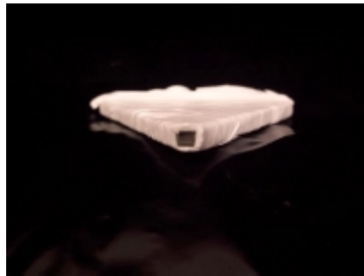
図 4.5: ライトガイドのAPD接着面
