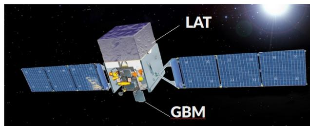
図 4.1 Fermi 衛星のイメージ\*2。積載されている直方体の装置が、本研究でデータを扱う LAT 検出器である。
