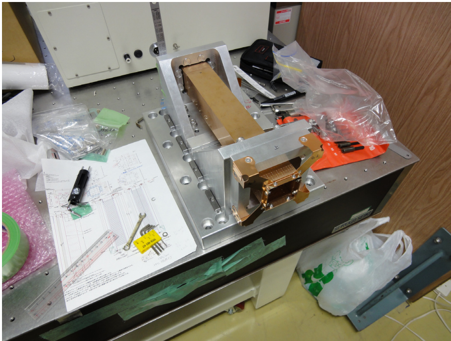
図 2.1: FC の概形。5 章で述べる振動試験の際、ハウジングを模擬した Al 製のマウントに取り付けた写真を示す。上の写真は前部 (天体側) から見たところ。下の写真は後部 (カメラ側) からみたところ。およそ 35 cm の長さの筒の前部につばが、後部に 4 本の足をもつ後部支持構造体ととりつき、これらをハウジングにネジ止めする。
