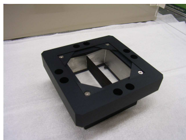
図 2.9: 狭視野偏光撮像用ダブルウォラストンプリズム
