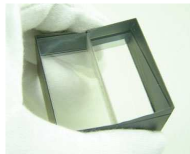
図 2.10: 広視野偏光撮像用ダブルウォラストンプリズム
