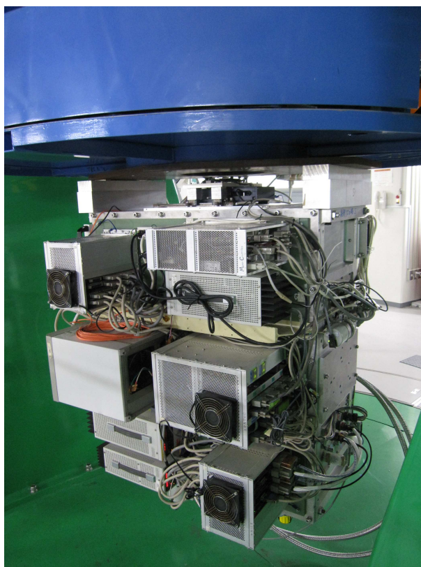
図 1.2: カセグレン焦点に設置された TRISPEC
