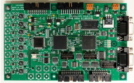
図 2.9: SpaceWire IF 搭載 FADC Board
