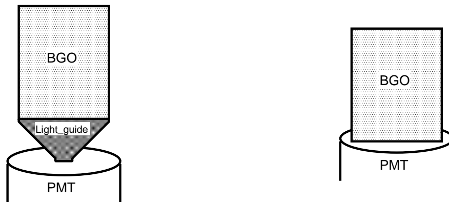
図 5.1: PMT によるライトガイドの集光性の検証実験セットアップの模式図：左側がライトガイドを装着した場合、右側が装着しない場合
