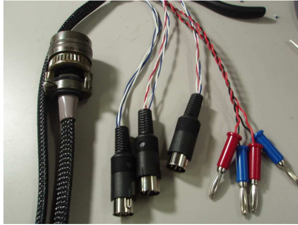
図 5.10: ハーメチックコネクタと温度計を接続するケーブル
