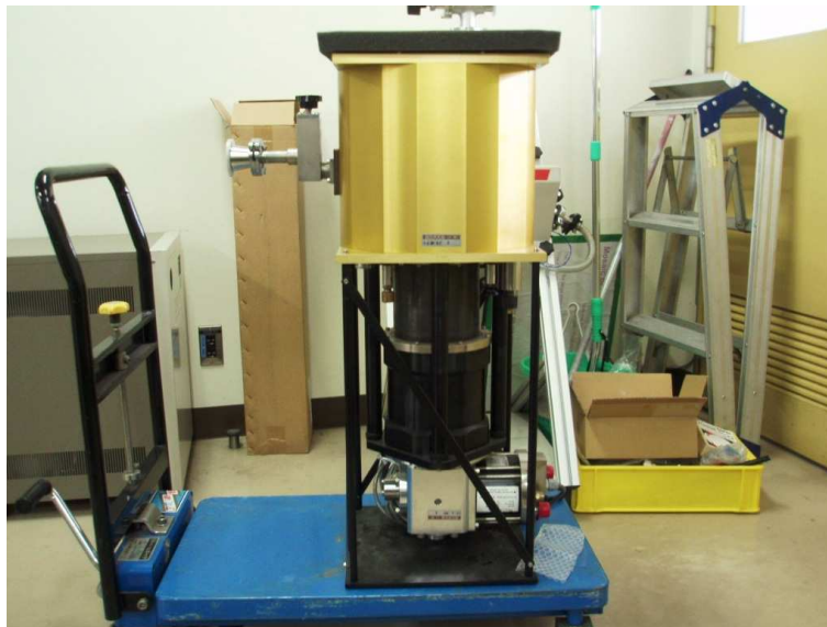
図 5.1: VIRGO-2K の冷却試験に用いることになるデューワー
