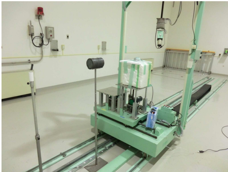
図 3.38: 校正場：鉛ブロックを設置した写真
