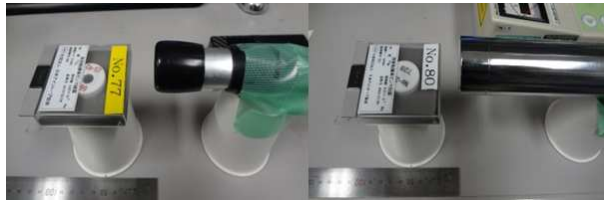
図 3.32: T-GMK2-S (左) と TCS-171 (右) の線量率比較実験
