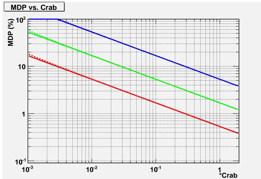
図 4.20: patternB 検出器のフラックスに対する  $MDP$ 。青、緑、赤はそれぞれ観測時間 10 ks、100ks、1Ms で観測した場合。図 4.19 と同様に、実線はバックグラウンドを無視した場合で、点線はバックグラウンドを考慮した感度曲線を示す。
