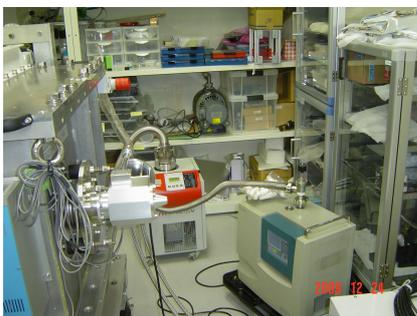
図 0.1 真空ポンプタイプの He リークディテクタを用いたリーク試験の様子
