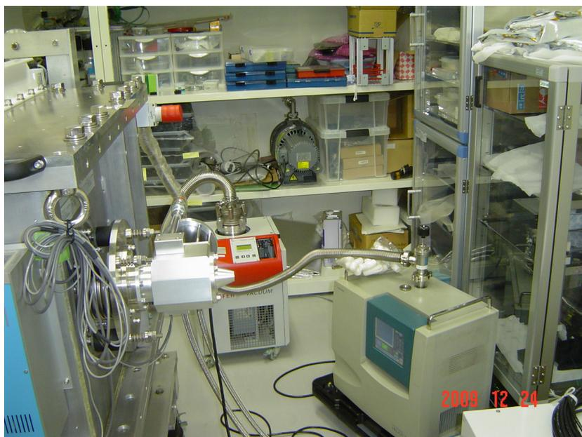
図 2.12 He リーク試験の実際のセットアップの様子
