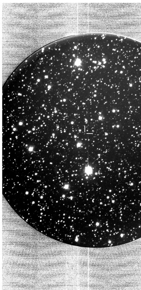
図 2.21: フラット画像で割った画像 . 図 2.20 から読み出しポートごとのカウントレベルが補正されたのが分かる .
