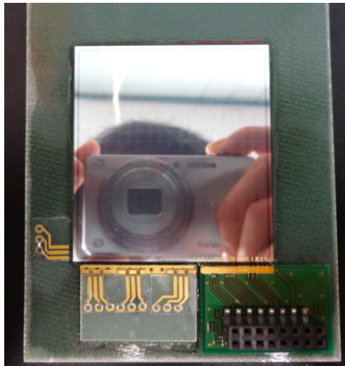
図 3.1: Pad1 と製作された読み出し基板 (右下) 左下は自作基板 (読み出しには用いない)
