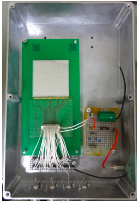
図 3.8: Si-Pad2 読み出しセットアップ
