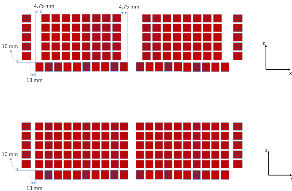
図 3.17: 上図が図 3.16 を y 軸負の方向から見た Low-Energy Calorimeter。下図が図 3.16 を x 軸正の方向から見た Low-Energy Calorimeter。
