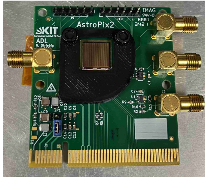
図 2.5: AstroPix v2（低比抵抗チップ）のキャリアボード。中央の黒い板で囲んでいる部分がチップ
