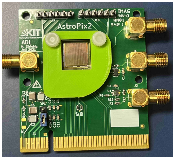
図 2.6: AstroPix v2（高比抵抗チップ）のキャリアボード。中央の黄緑の板で囲んでいる部分がチップ
