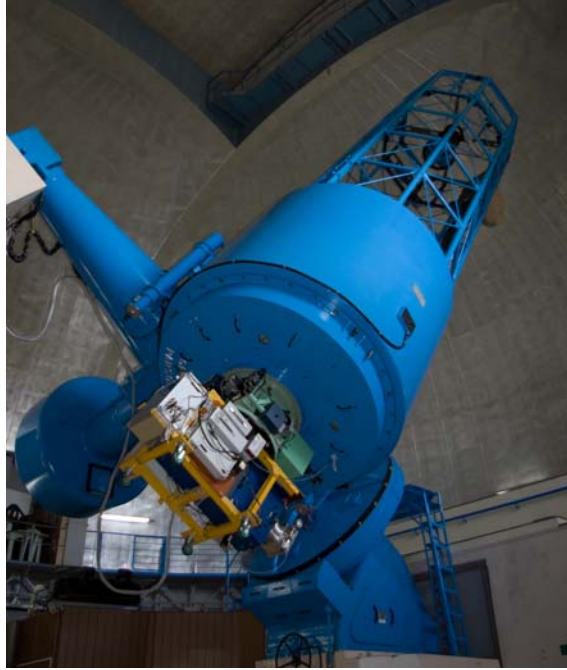
図 3.4: 188cm 望遠鏡に搭載した KOOLS の概観 [26]
