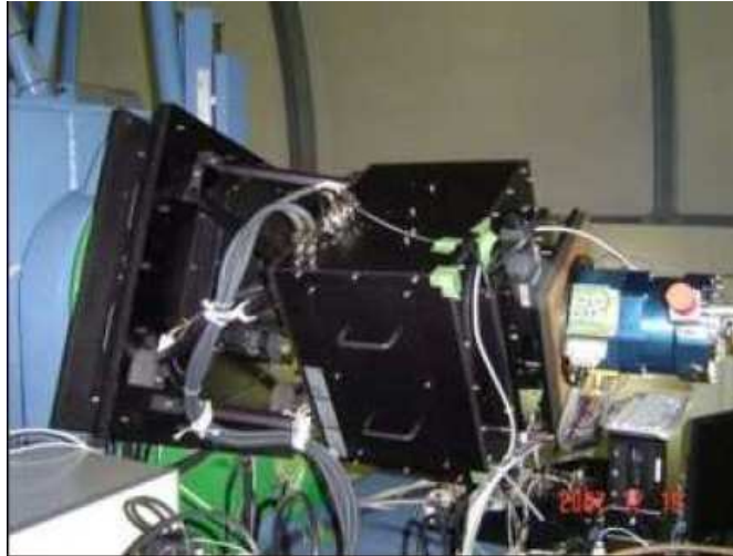
図 2.4: 一露出型広視野偏光撮像器 HOWPol
