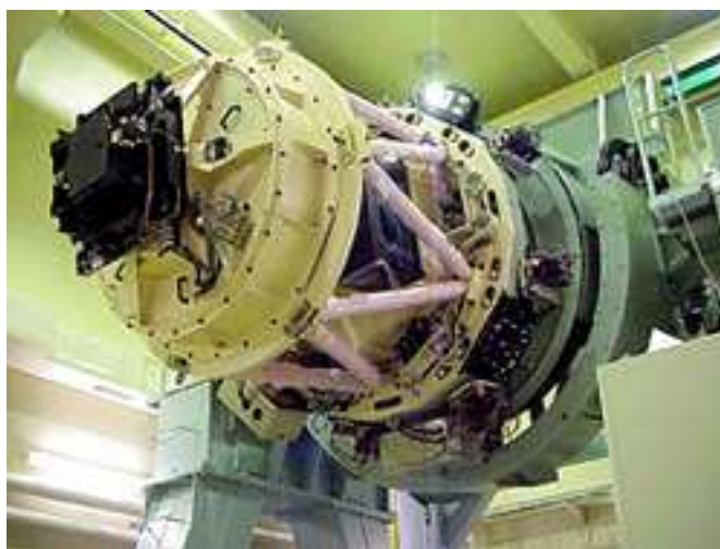
図 2.7: 微光天体分光撮像装置 FOCAS
