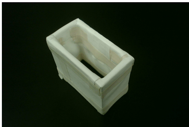
図 3.1: ゴアテックス反射剤が巻かれた簡易 BGO アクティブシールド
