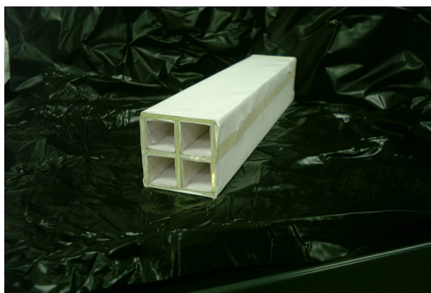
図 3.2: ゴアテックス反射剤で巻かれた HXD 用 BGO-well
