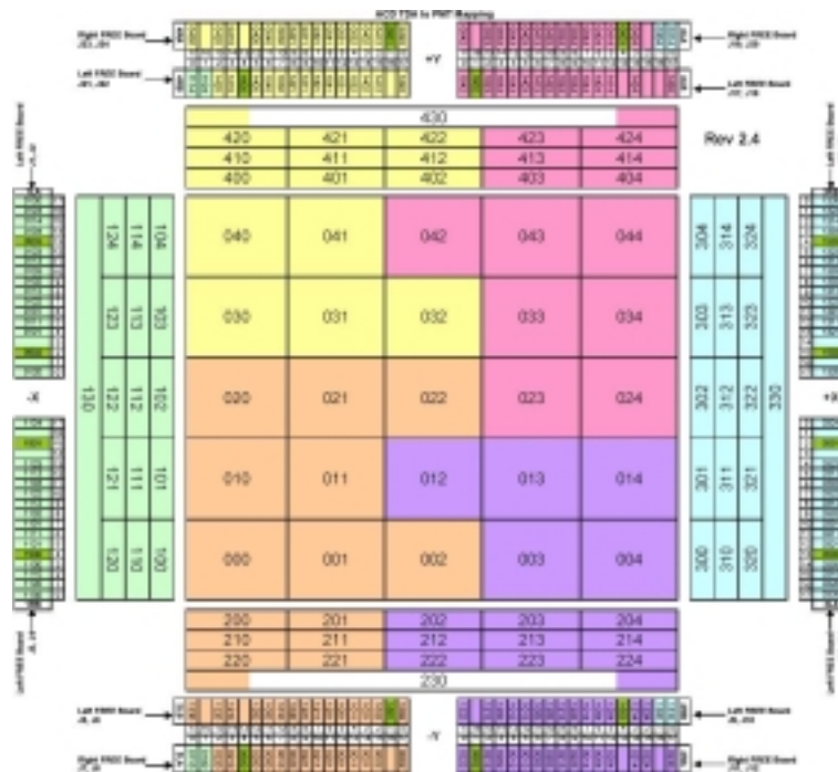
図 2.2: ACD のプラスチックシンチレータタイル分割の様子。self-veto による影響を最小限にするため、タイル分割を最適化している。最外周の細かい記述は読み出し PMT の番号である。
