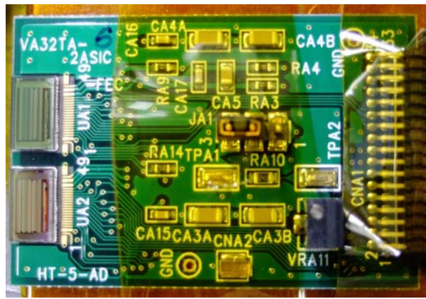
図 4.16: VA32TA6 が搭載された FEC の写真。この FEC には VA32TA6 が 2 チップ搭載されている
