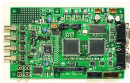
図 3.20: 汎用 FADC Board。12 bit, 6 MSPS の ADC が搭載されている。ロジックの試験という目的では問題無く使用できる。
