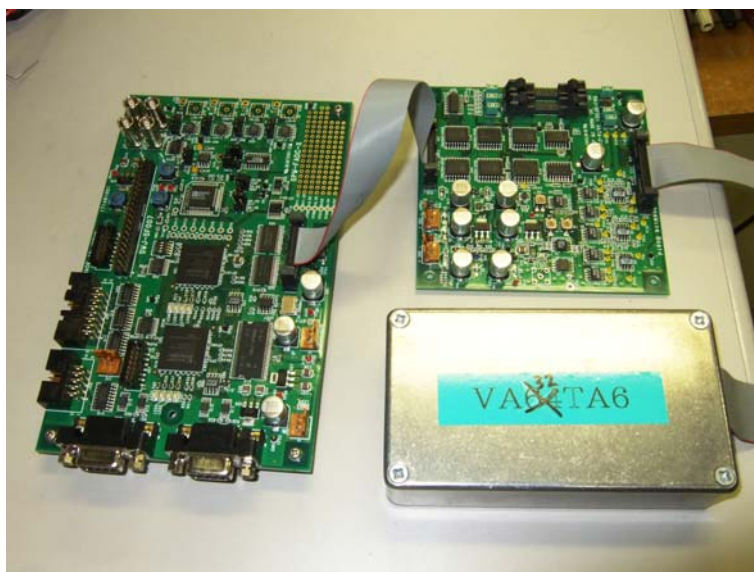
図 4.24: Xilinx 版 FADC Board を使用した VA32TA6 読み出しシステム。
