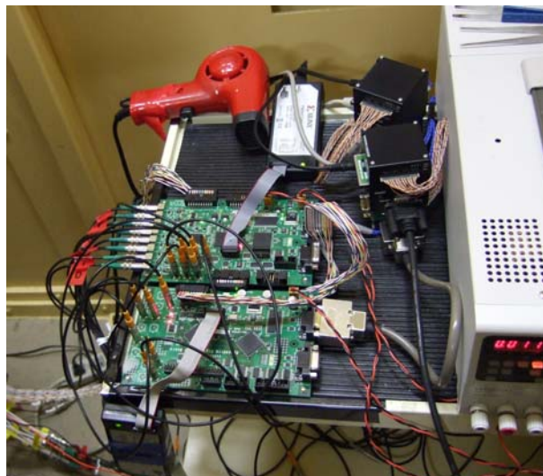
図 3.31: KEK ビーム試験における DAQ システムの写真。
