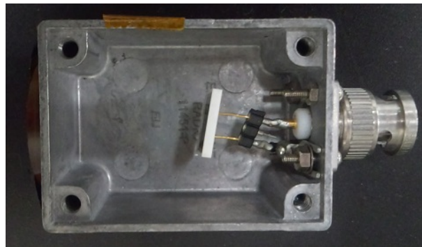
図 4.2: 本節で再現する実験セットアップ。アルミ製の箱に囲われた Si フォトダイオードに ^{241}\text{Am} をあてスペクトルを取得する。
