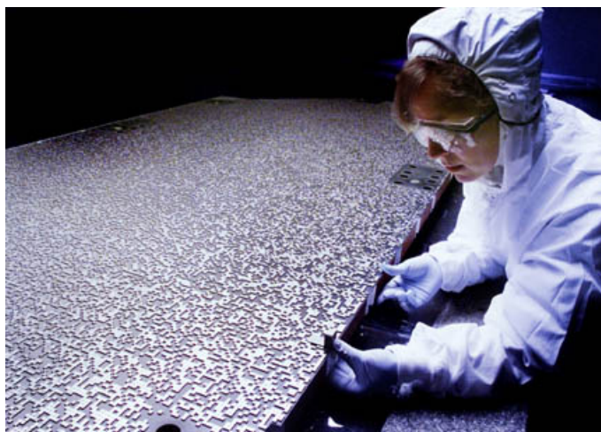
図 2.3: Swift 衛星の coded mask の開発風景 [45]。作業員の女性が手にしているのが、開発中の coded mask である。
