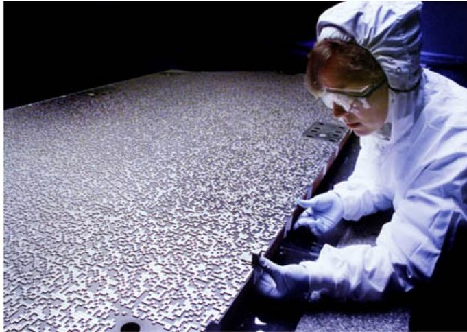
図 2.3: *Swift* 衛星の coded mask の開発風景 [24]。作業員の女性が手にしているのが、開発中の coded mask である。
