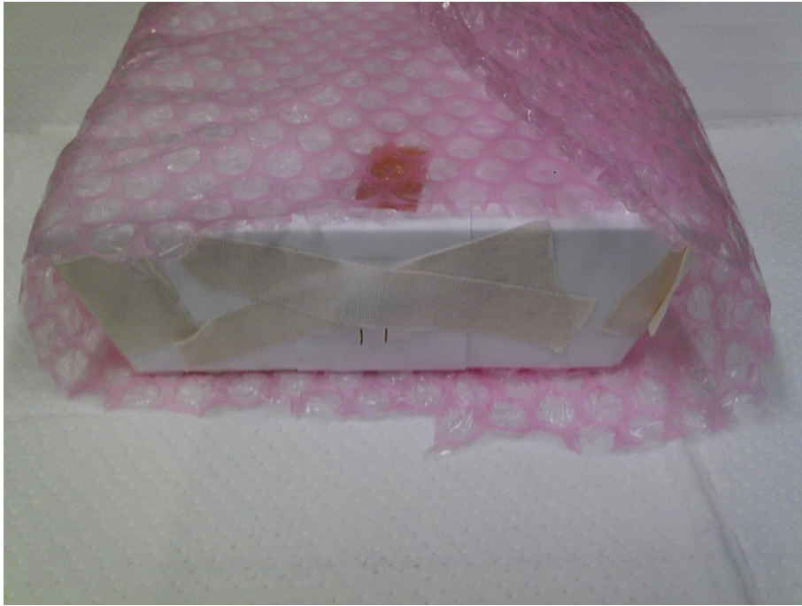
図 3.6: APD を固定し、エアパッキンで包んだ BGO(Type-C1)
