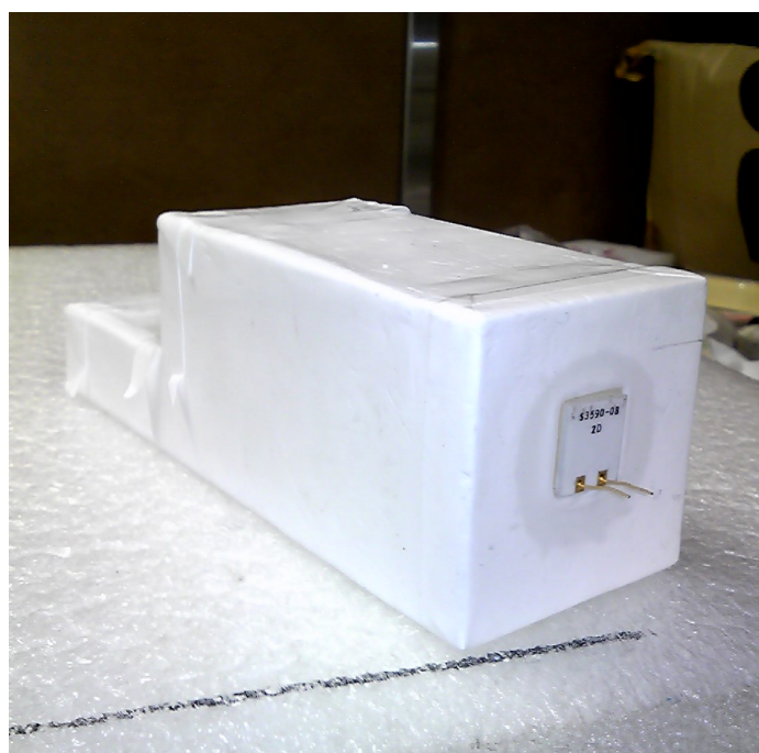
図 3.5: 反射材を 2 重に巻いた BGO にオプティカルグリスで APD を接着した。
