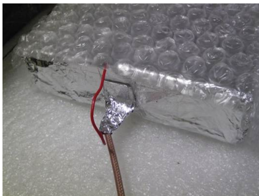
図 3.2: 反射材を巻き、更にアルミ箔で覆った BGO に APD を取り付けしている。
