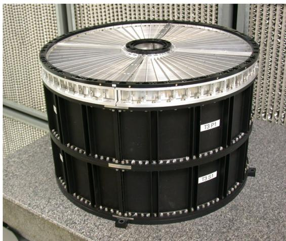
図 3.10: Suzaku 搭載望遠鏡 XRT
