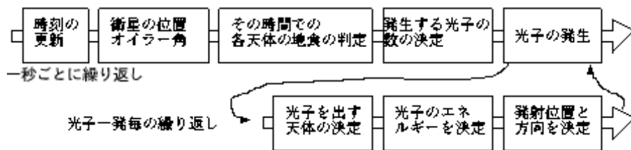
図 3.3: 天体のシミュレーションプログラムの流れ
