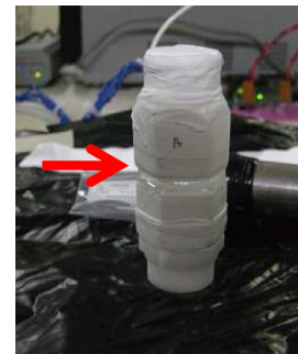
図 3.8: 中性子カウントモニターの構成 (BGO で挟まれるように LiCAF (Eu 2%) 設置するホスウィッチ構成である)
