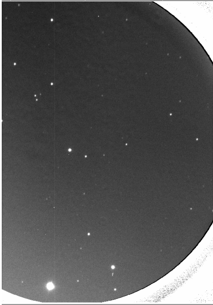
図 21 V バンドフラット画像によるフラット補正を行った画像
